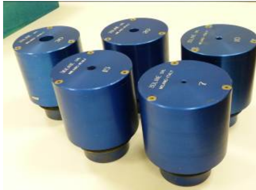
Figura 10.- Colimadores cónicos de 3D Line® utilizados en el tratamiento de RC en el IVO.
