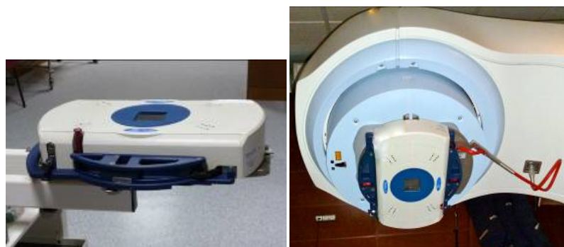
Figura 12.- Microcolimador multiláminas marca Brainlab®(izda) acoplado al A. Lineal Oncor de Siemens (der) durante un tratamiento de RC de la 2ª fase.
