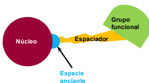
Figura 3. Partes de una AuNP funcionalizada con un ligando orgánico.
