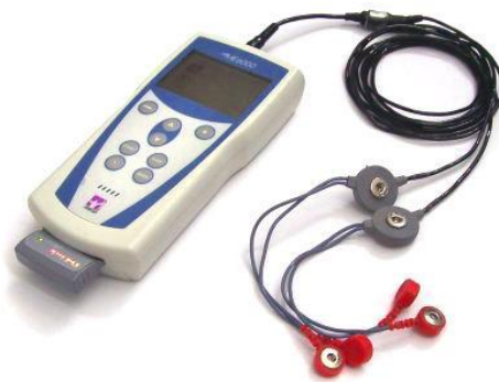
Figura 25. Sistema de electromiografía de superficie para la valoración de la actividad muscular.
