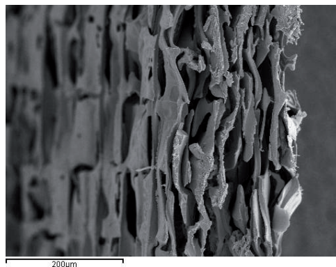
Figura 2.21: Micrografía SEM del scaffold de PMMA- i -PMMA, 1% en peso EGDMA a partir de un template de 33 capas de nylon a (13.2 \pm 0.5) 10^7 Pa. La sección transversal se muestra en la parte derecha de la imagen y la superficie exterior en la izquierda. Barra de escala 200 \mu\text{m} .
