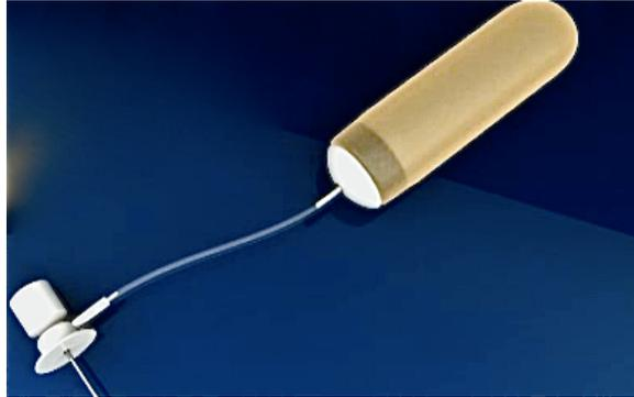
**Figura 4.7.** Esquema de la bomba Alzet® conectada a la cánula de Plastics One (modelo 3220P/Spc) mediante un tubo de polietileno (PE 10).
