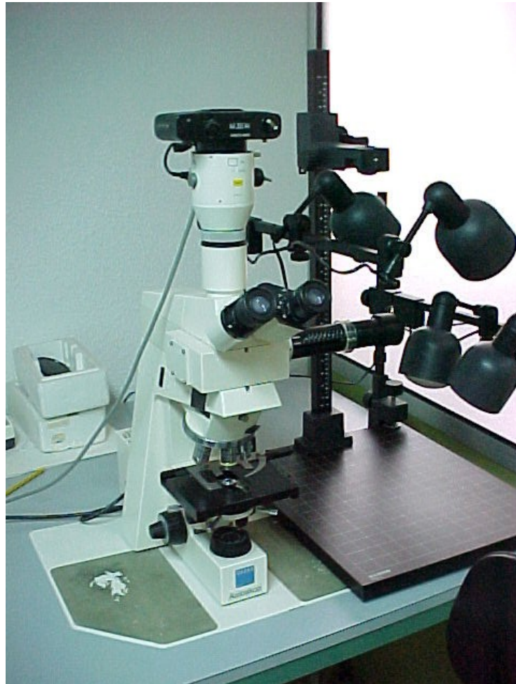
Fig. 3.13. Microscopio Axioskopp de Zeiss con cámara clara acopada.
