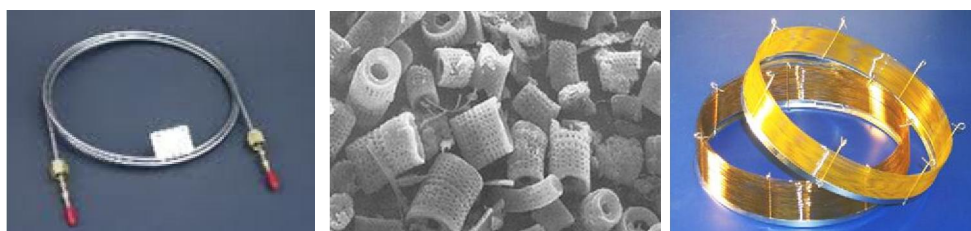
Fig. 8. Columna d'acer reblerta de diatomita (centre) i columnes capil·lars de sílice
