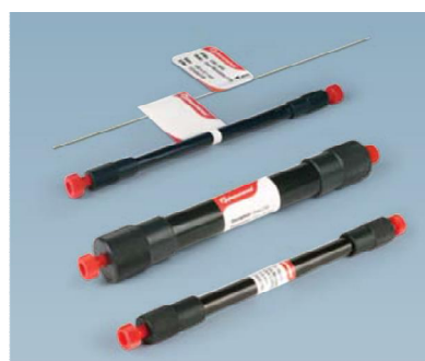
Fig. 3. Columnes capil·lar de sílice (dalt) i plàstic PEEK (tres de baix) per HPLC
