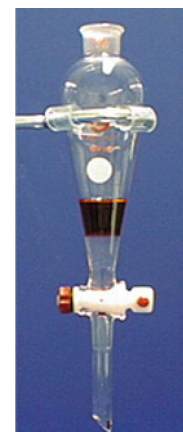
Fig. 5. Embut de decantació
