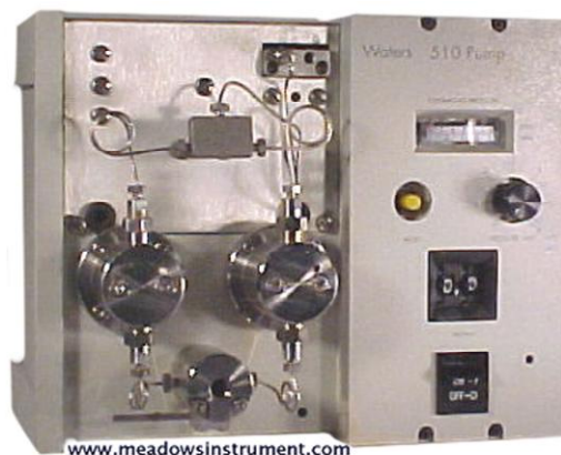
Fig. 11. Mòdul de bombes de doble pistó: les eixides dels dos cilindres van a parar a l'amortidor d'impulsos
