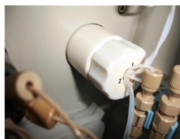
Fig. 6. Cromatògraf iònic i detall del compartiment amb les tres columnes supressores
