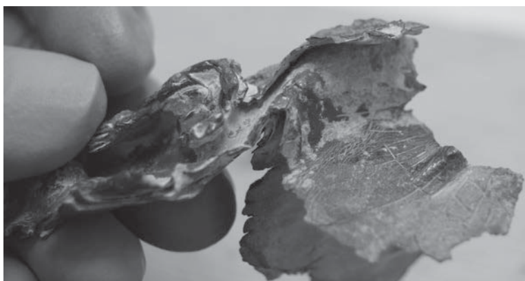
Fig. 9: Detalle del desplegado del plomo.
