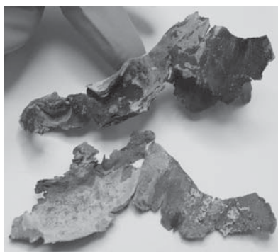
Fig. 8: Detalle del desplegado del plomo.
