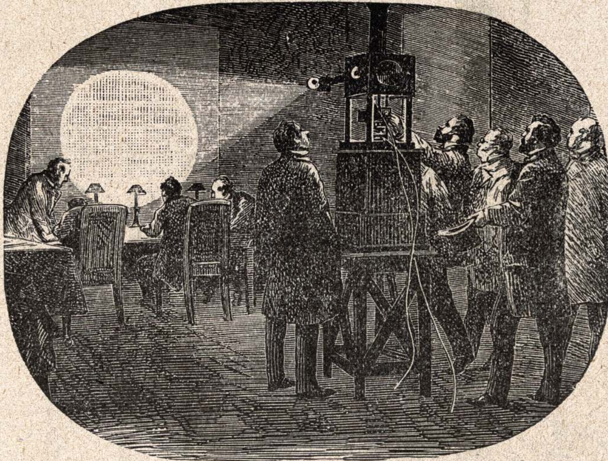
Fig. 634. Proyección de despachos microscópicos por medio del microscopio fotoeléctrico.
