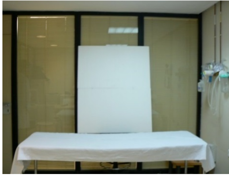
Figura 5.6. Placas de poliestireno expandido para evitar contaminación térmica.
