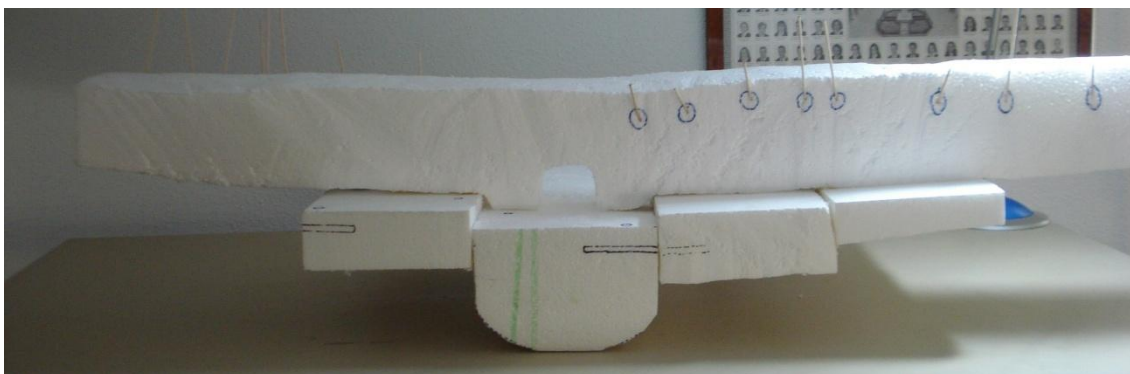
Fig. 418.- Vista del modelo de estudio en poliestireno en la zona de la quilla. La flexibilidad del material soluciona y corrige el problema real de acople de las piezas, sin embargo es una ilusión óptica puesto que la madera no tiene esa propiedad tan acusada.
