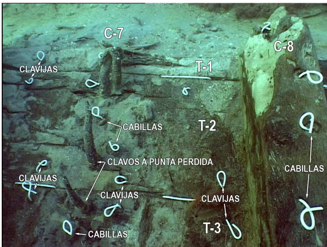
Fig. 291.- Distribución de las cabillas de madera y los clavos de hierro a punta perdida en la cuaderna 7, desaparecida en el pecio. (Foto: Autor).
