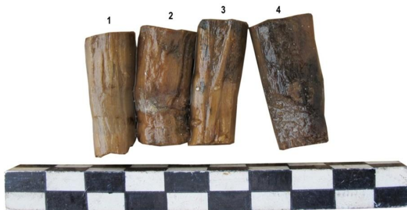
Fig. 457.- Ejemplo de cuatro clavijas troncocónicas del pecio del s. IV a.C. de Binissafüller donde se aprecia sobre todo en la clavija nº 1 y 2 la erosión a mitad de su recorrido por la fricción contra la espiga al flexionarse y torsionarse infinitamente el casco por la acción de la navegación (Foto: Autor)
