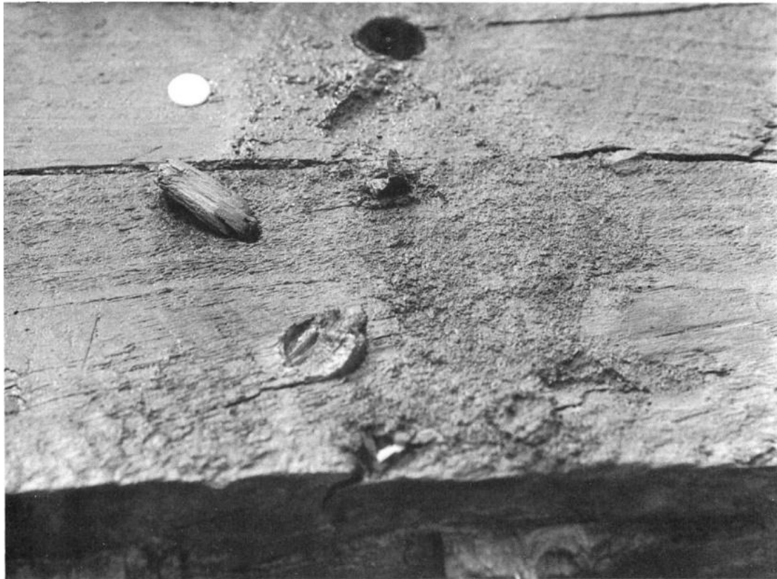
Fig. 345.- Vista de la cara superior del casco donde se observa como una de las clavijas clavadas desde el exterior se queda retorcida por la presencia in situ de la cuaderna correspondiente. (Liou, Gassend 1990: 239)
