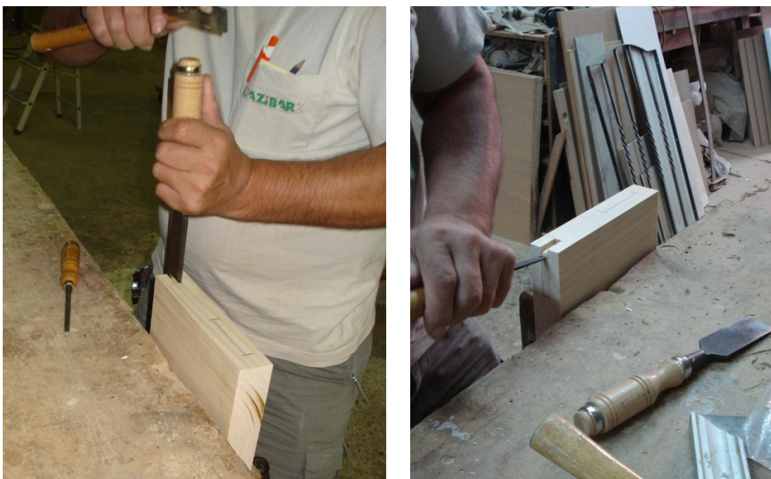
Fig. 438.- Dos momentos de la primera realización de una mortaja en la madera resinosa. Se inició la experimentación con una lateral incompleta para a continuación proseguir con una mortaja completa.
