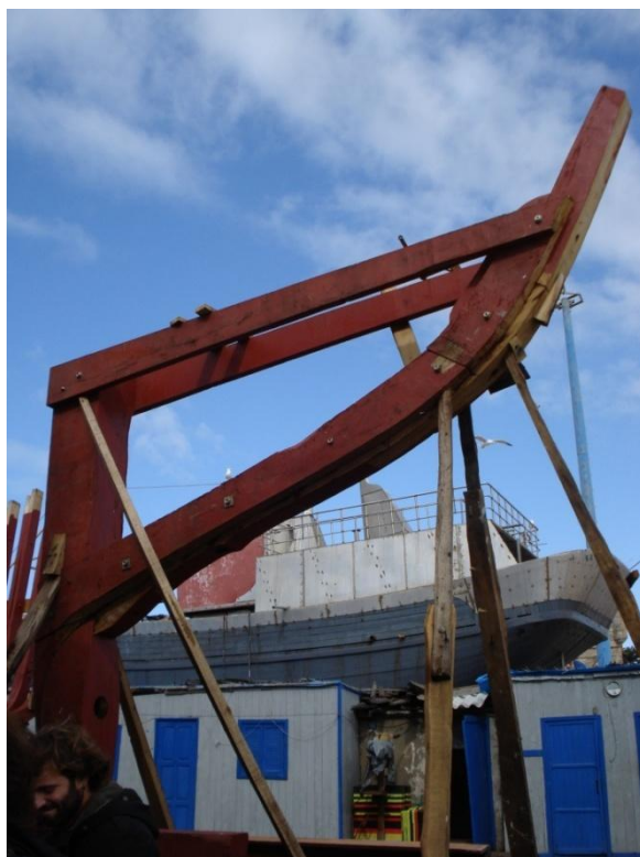
Fig. 34.- Astillero tradicional en madera de Essaouira (Marruecos). Particular ensamblaje de las piezas de la roda de un pesquero de 20 m aprox. de eslora en proceso de unión con el casco. (Foto: Autor).
