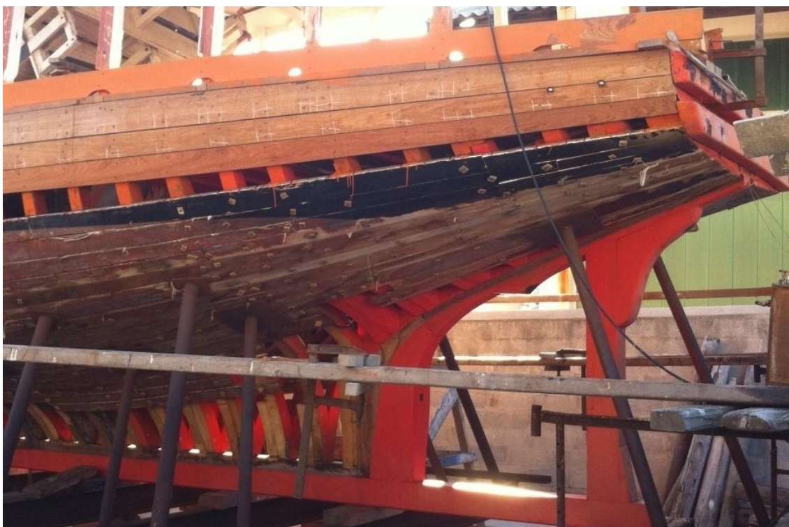
Fig. 35.- Astillero tradicional en madera de Marsella. Marcaje por los carpinteros de la situación de genoles y barraganetes en el forro mediante líneas a tiza, para su claveteado. (Foto: Autor).
