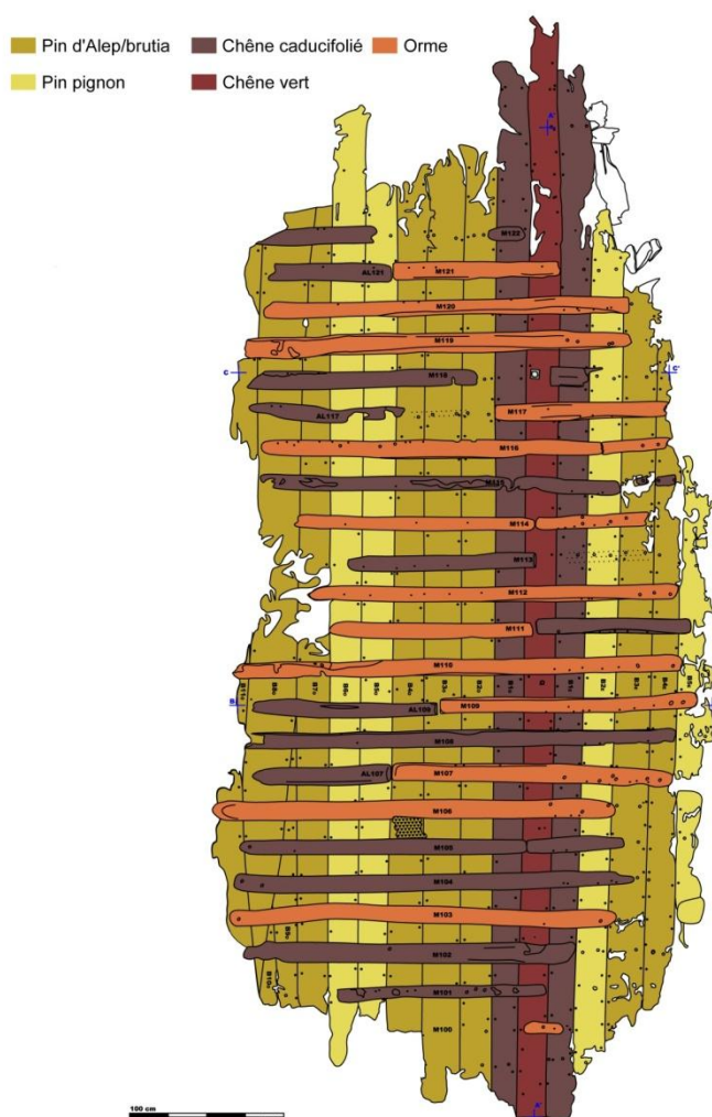
Fig. 316.- Repartición de las especies vegetales en el casco del Giraglia 2 . Obsérvese la homogeneidad de la carpintería axial y transversal con especies de gran dureza (roble, encina y olmo) (Dibujo: Greck).
