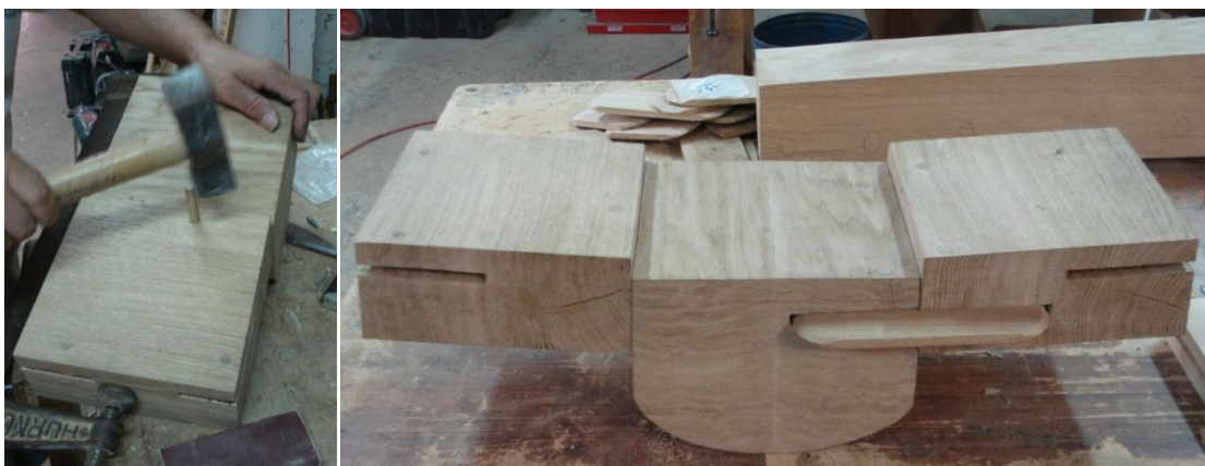
Fig. 437.- Durante la colocación de las clavijas de fijación entre la quilla y la traca de aparadura B1o. Montaje con las espigas de la quilla y las tracas de aparadura.
