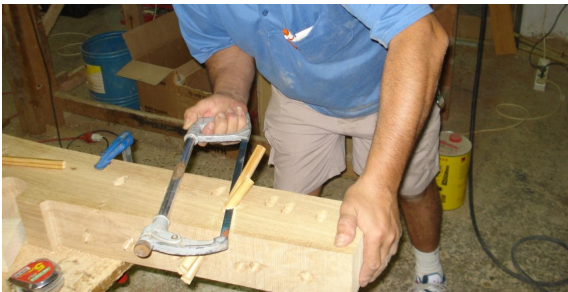
Fig. 446.- Durante el serrado de los sobrantes de las dos cabillas utilizadas en el ejercicio.
