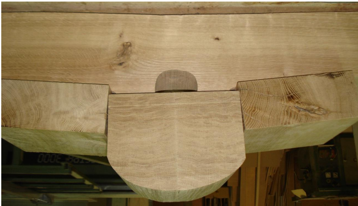
Fig. 424.- Vista de la quilla, tracas de aparadura y varenga, presentadas. Obsérvese que existe un pequeño ángulo de desacople en las piezas de la carpintería axial si están en contacto directo con la cuaderna M109.
