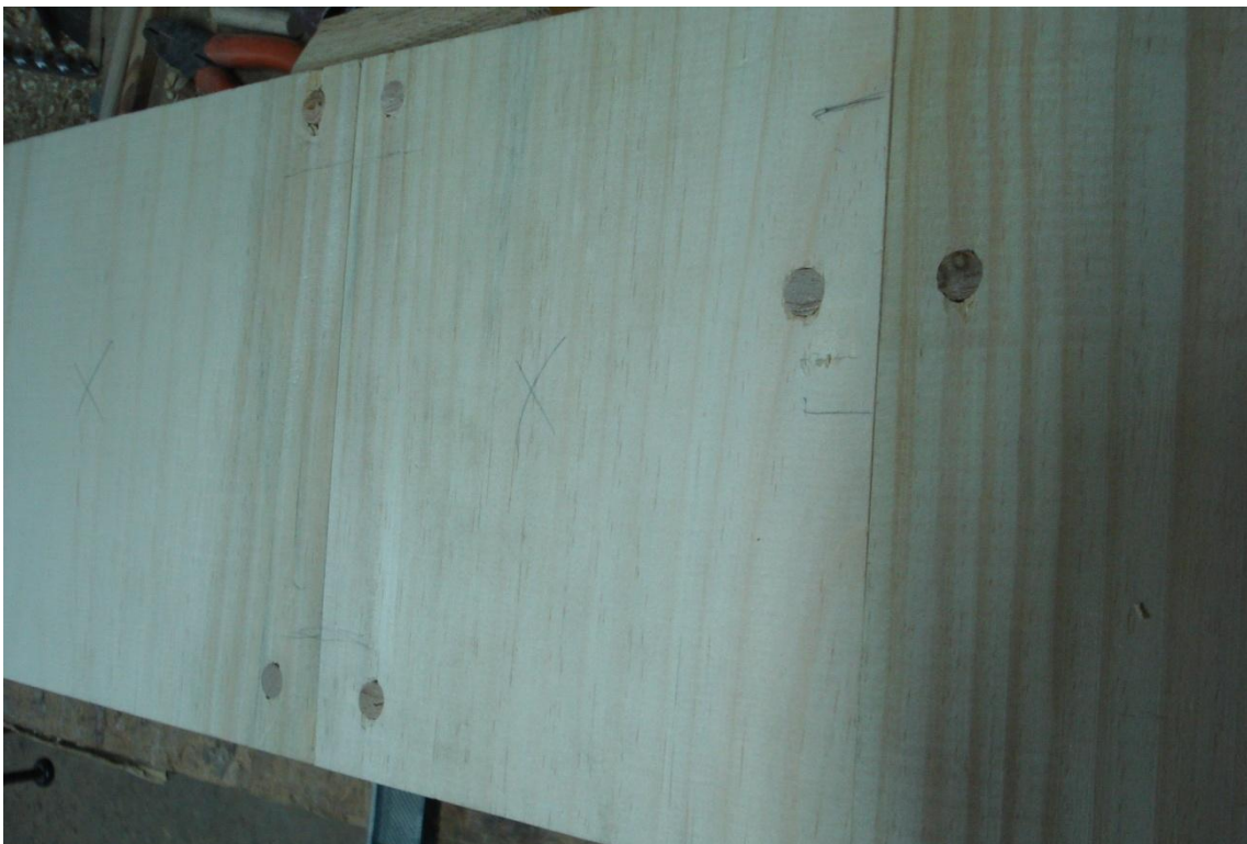
Fig. 442.- Observación de la cara exterior del casco en el modelo. La distribución de las espigas en las tracas de forro era a tresbolillo.
