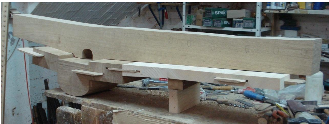
Fig. 440.- Modelo con la traca de casco B4E colocada. La cuaderna M109 solo está presentada, sin ningún tipo de unión con el casco.
