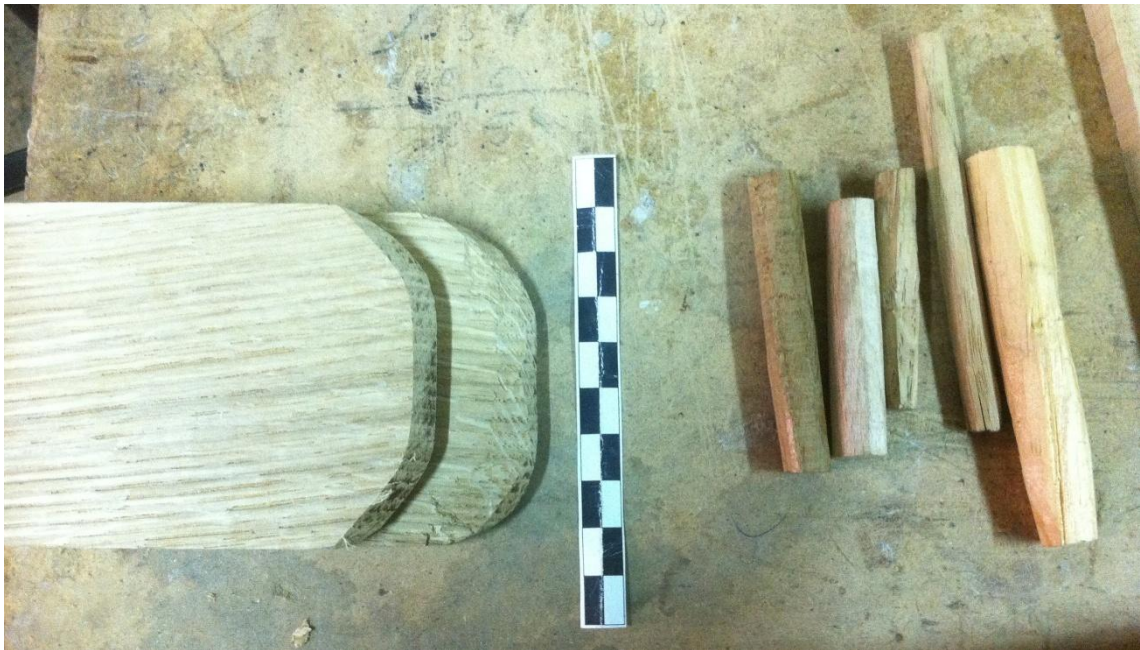
Fig. 434.- Biselado de las espigas realizado con lija de papel o con cuchilla. Clavijas realizadas a cuchilla partiendo de listones de sección cuadrada.
