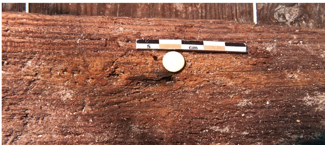
Fig. 323.- Ejemplo de la cara superior de una cuaderna con la presencia de la oquedad de un clavo de hierro de sección cuadrada de 2 mm de lado, junto con las manchas características de este tipo de oxidaciones (Foto: Seguin).
