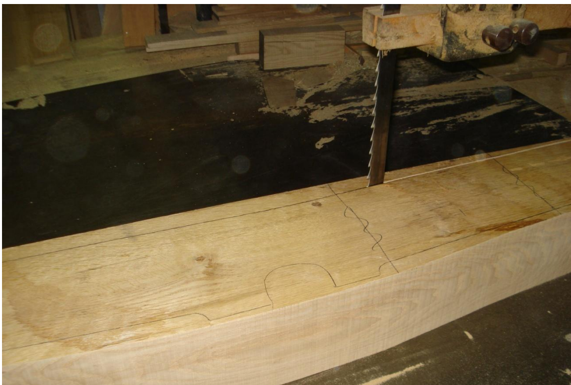
Fig. 423.- Durante el corte de la varenga mediante sierra eléctrica. Obsérvese el dibujo a lápiz basado en la plantilla rígida fabricada con anterioridad.
