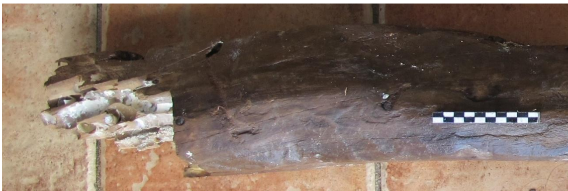
Fig. 48.- Ejemplo de un extremo de cuaderna del pecio de Binissafúller donde se observa en la parte izquierda de la imagen, las cavidades dejadas por el Teredo navalis . (Foto: Autor)
