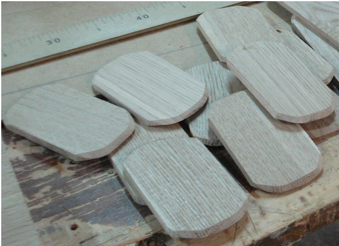
Fig. 435.- Varias de las espigas ya fabricadas, donde las vetas indican que provienen de \frac{1}{4} de tronco.
