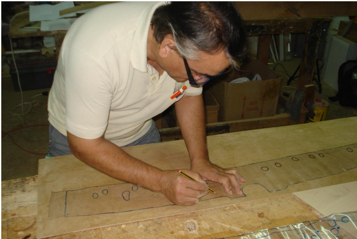
Fig. 419.- Durante la fabricación de la plantilla de corte para la varenga M109 en la carpintería.
