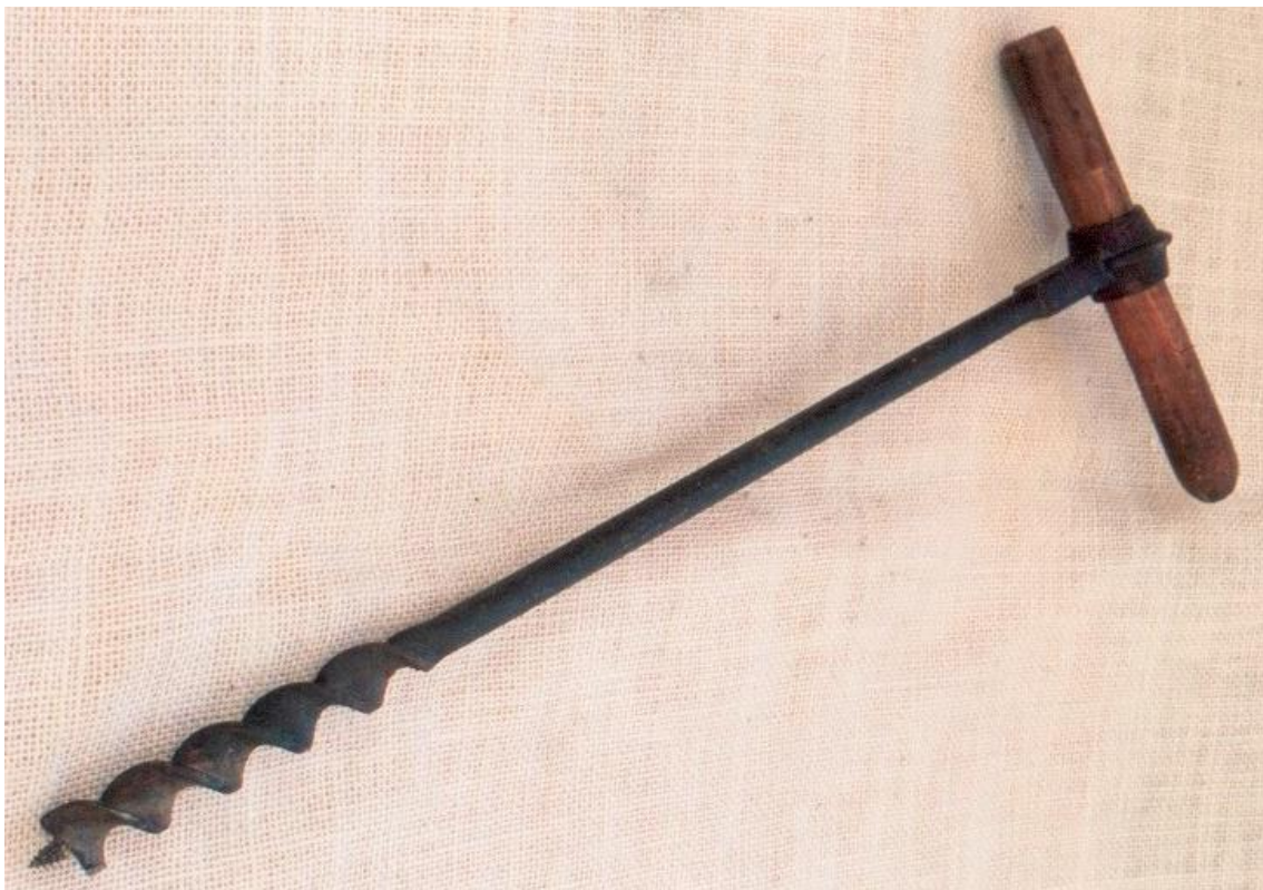
Fig. 443.- Barrena tradicional en hierro. Obsérvese como presenta una punta con una rosca en espiral de pequeño tamaño para perforar inicialmente y ayudar a introducir las aspas de la rosca de mayor tamaño. (Foto: Museo de la Agricultura de Torremocha de Jarama-Madrid)
