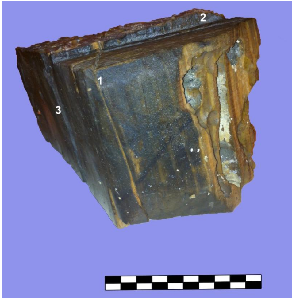
Fig. 285.- Vista inferior del fragmento de carlinga situado hacia el E. En él puede observarse 1.- Todos los bordes del tacón que encaja entre las varengas estaban biselados, dando aspecto lateral de una media luna; 2.- Podemos observar el ángulo recto que se forma entre el tacón de entrada entre las varengas y la cara inferior de la carlinga que se apoya en la cara superior de la varenga; 3.- Se ha producido una acanaladura por fricción producida por la tabla al E sobre la que reposa otra hilada de lingotes no excavada durante la campaña 2012. (Foto: Autor).
