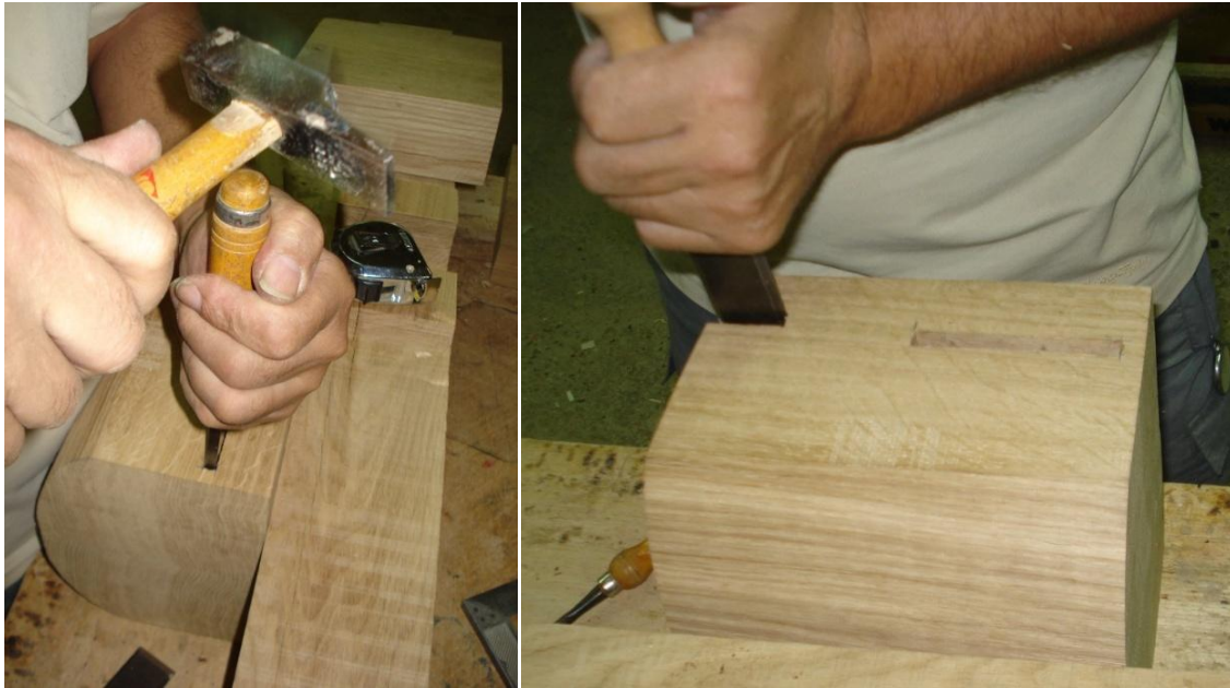
Fig. 431.- Dos vistas durante la realización de las mortajas de la quilla. Se inició la experimentación por una mortaja que daba al perfil para continuar por otra ya completa.
