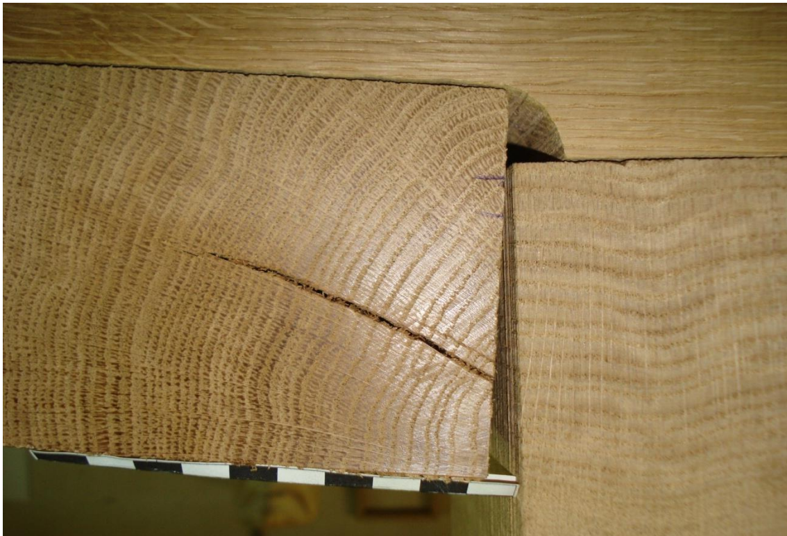
Fig. 425.- Primer plano del ángulo de contacto entre la traca de aparadura y la quilla.
