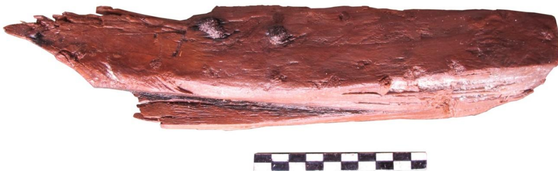
Fig. 501.- Fotografía del un fragmento en madera de la punta de la roda/codaste del Binissafúller donde se aprecia el arranque del alefriz para dar alojamiento a la traca de aparadura, las concreciones de una hipotética anilla y ya de una manera menos visible, las clavijas de fijación de un cosido ya desaparecido. (Foto: Autor)
