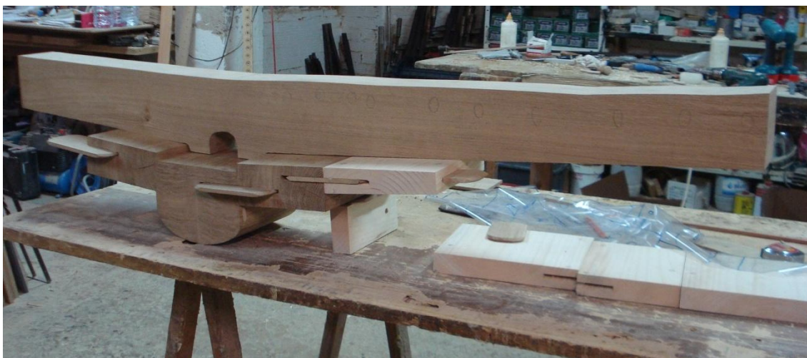
Fig. 439.- Montaje de la M109 sobre el conjunto definido por la quilla, tracas de aparadura y segunda traca (B2 F )
