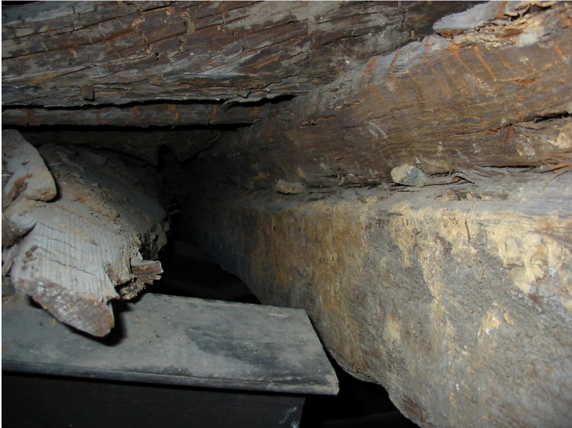
Fig. 355.- Vista del alefriz con encaje del codaste del pecio de La Bourse . (Foto: Autor)
