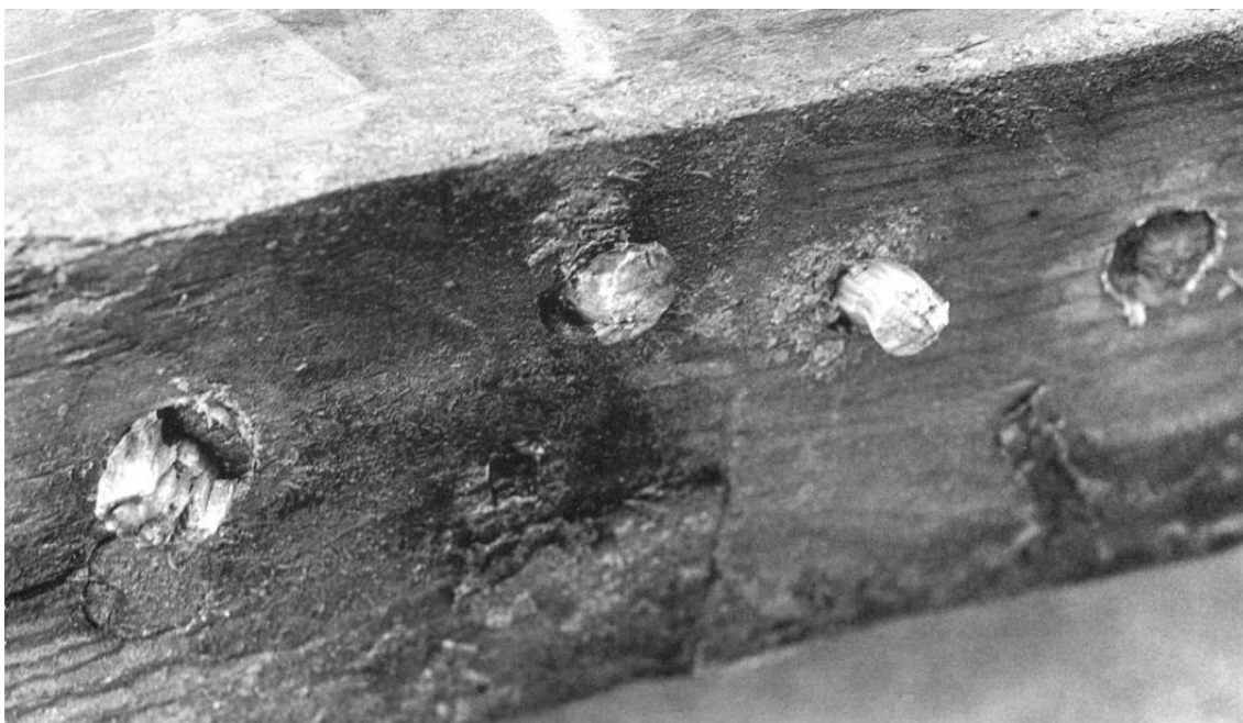
Fig. 344.- Vista de la cara inferior de una cuaderna con dos clavijas de la junta de las tracas del casco que llegan a quedar clavadas en ella. (Liou, Gassend 1990: 239)
