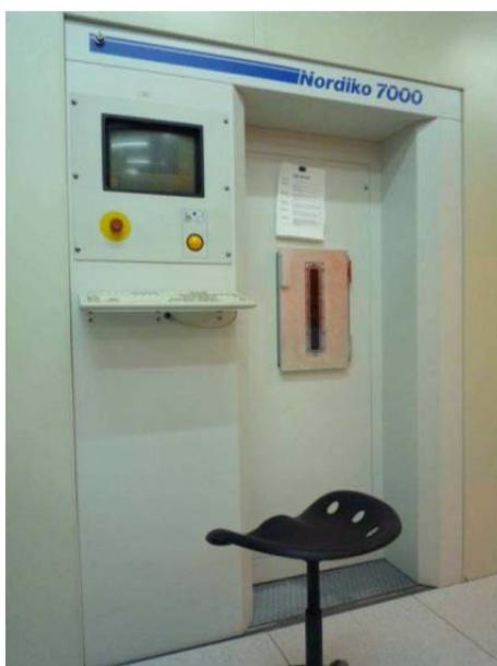
Fig.A-6. Fotografía de la interfaz de usuario del equipamiento Nordiko 7000 desde el interior de la sala limpia.
