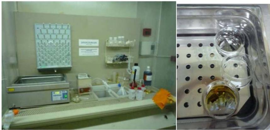
Fig.A-11. Fotografía de la zona de trabajo y detalle del baño húmedo instalado en la zona gris de la sala limpia.
