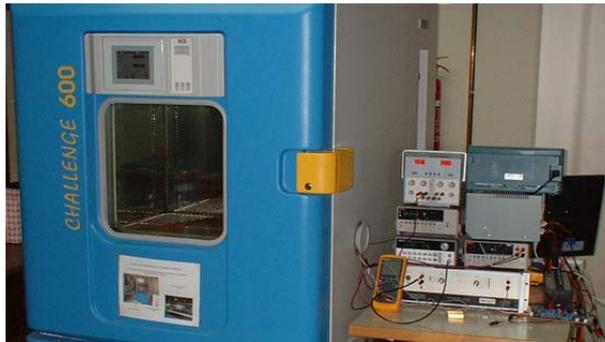
Fig.6-36. Visión real del banco de pruebas para caracterización térmica.
