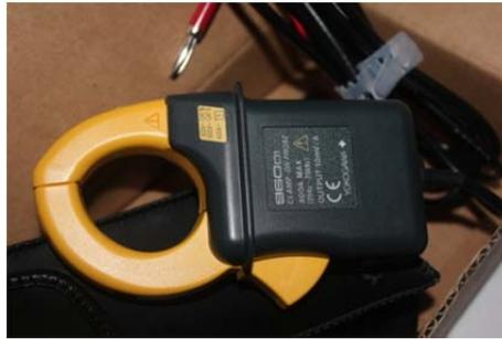
Fig.8-3. Imagen de la sonda de corriente de referencia modelo 96001 del fabricante Yokogawa.
