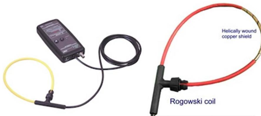
Fig.3-5. Detalle de conexión de un transductor de corriente del fabricante PEM.
