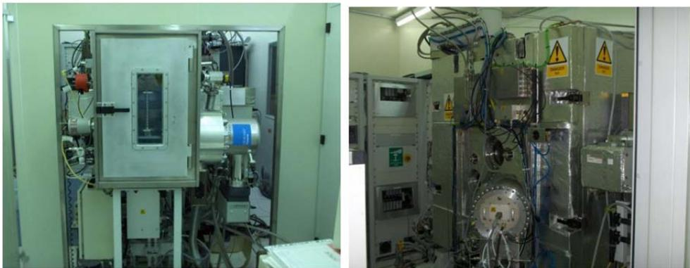
Fig.0-10. Fotografías de la máquina Nordiko 3600: interfaz de usuario en el interior sala blanca (izquierda) y cámara principal en el exterior de la sala blanca (derecha).
