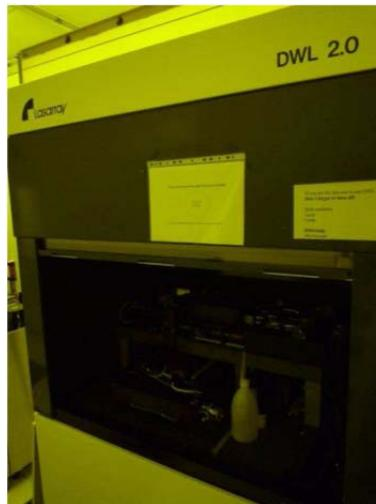
Fig.A-3. Fotografía de la máquina de escritura láser DWL instalada en la zona amarilla de sala limpia.
