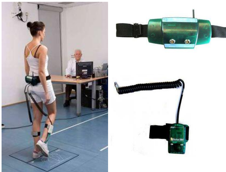
Figura 20. Componentes del equipo de medición de presiones plantares Biofoot/IBV .
