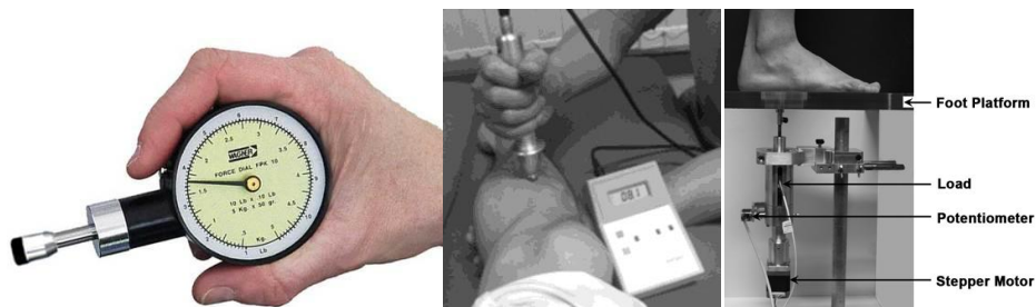
Figura 12. Dinamómetro analógico (izqda.). Dinamómetro digital (centro) (Fuente: Maeda et al. , 2011). Dispositivo desarrollado por Xiong (dcha.) (Fuente: Xiong et al. 2010).
