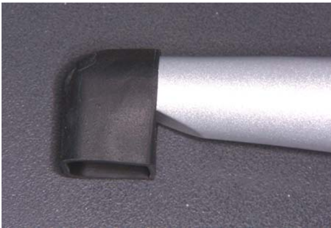
Fig: La cubierta de plástico negro puede ser de dos tamaños. En el mango de la cámara se debe señalar cuál es la que se está utilizando. En todo el estudio hemos utilizado la grande, que es la que aparece en la fotografía.
