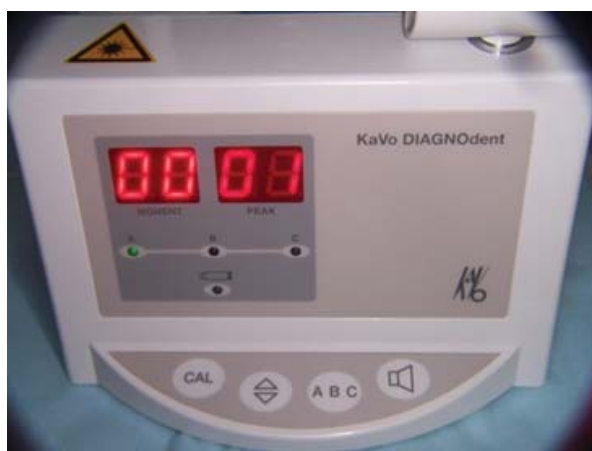
Fig: cuerpo del sistema diagnóstico, donde se observan dos pantallas. En la primera "moment" hace referencia a la lectura que se da en ese momento. En la otra, "peak" hace referencia a la lectura máxima alcanzada por el dispositivo durante ese diagnóstico
