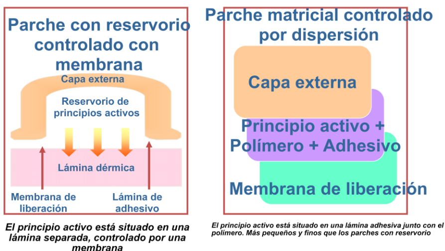
Fig.74 Tecnología del parche transdérmico con Rivastimina (Exelon®). Reservorio versus Matricial (Cortesía: Novartis Farmacéutica).
