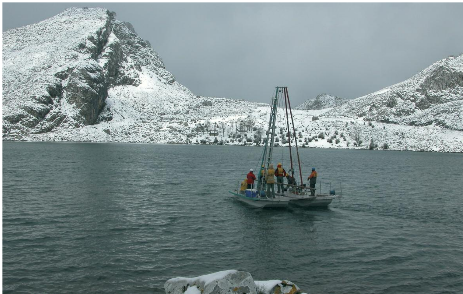
Figura 87. Sondeo del Lago Enol en mayo de 2004 con una plataforma flotante del Limnological Research Center
