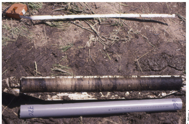
Figura 437. Uno de los tramos obtenidos en el sondeo de Espinosa de Cerrato
