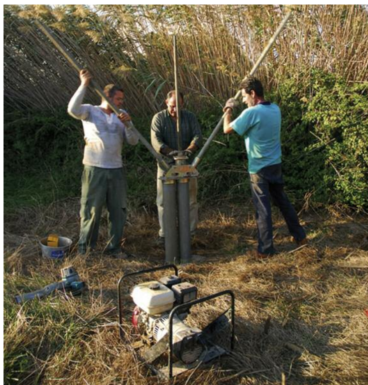
Figura 715. Trabajos con equipo portátil durante una de las campañas de sondeo en las Islas Baleares
