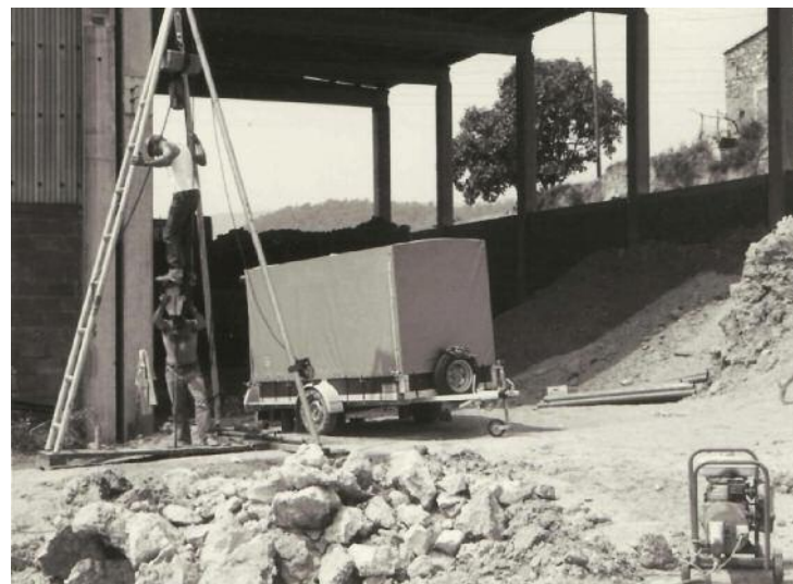
Figura 287. Maniobra de muestreo del testigo BO-II en 1983 sobre el suelo de la cantera de Bòbila Ordis
