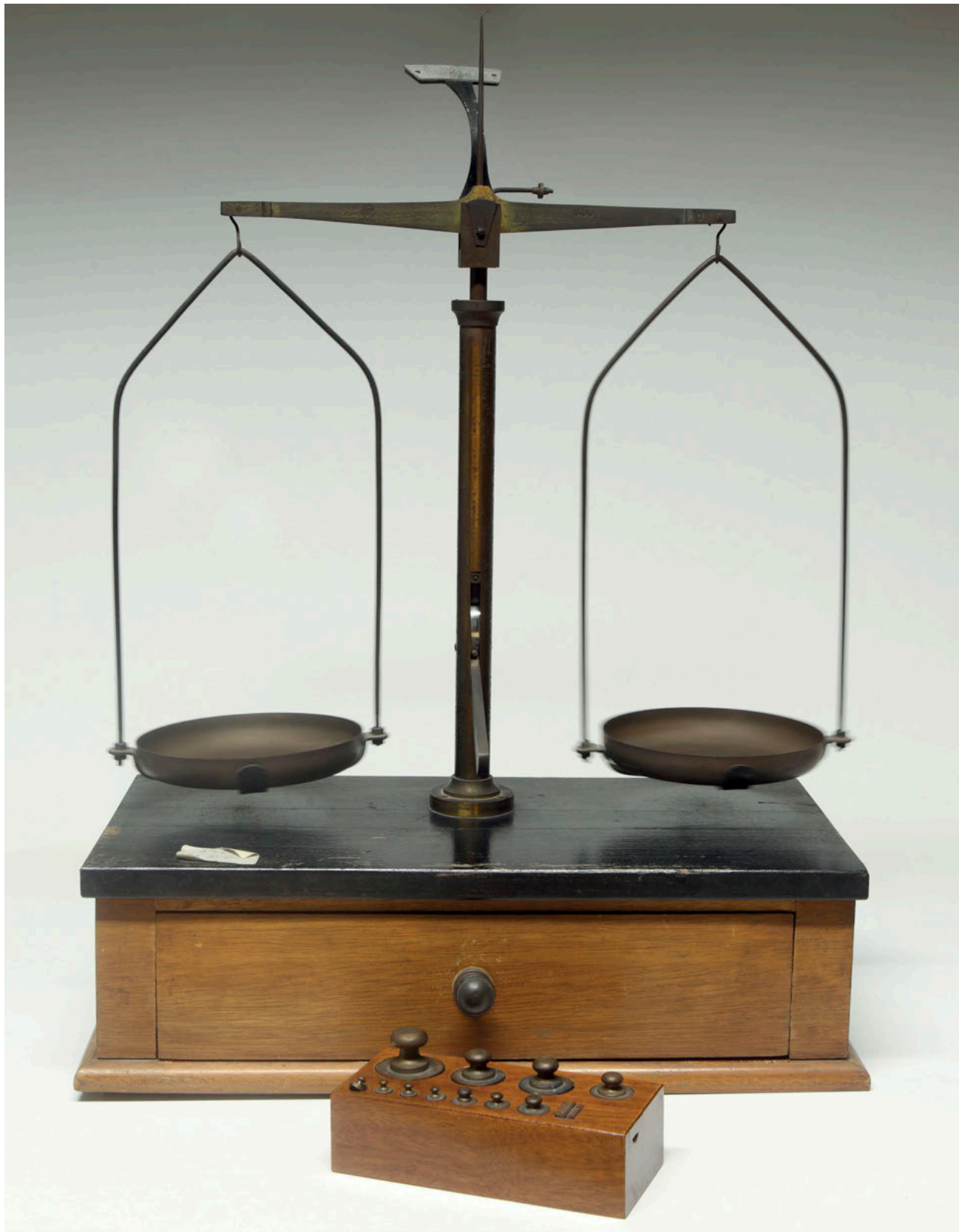
Balança de precisió. Ferro amb martel·lé, baquelita, plàstic i llautó. 36 x 16 x 9 cm. Fabricant Cobos, sèrie 7640 2034, c. 1950-1970. Laboratori de Termodinàmica «Vicente Gaudí». Col·lecció d'Instrumentes Científics de la Universitat de València. [Núm. Inventari: UV 9847. Núm. Col·lecció: M-0048]
