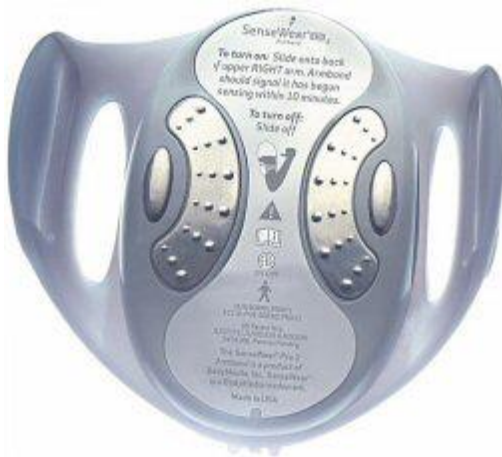
Figura 13. Vista posterior del Armband donde se pueden apreciar los sensores de temperatura y de corriente galvánica.
