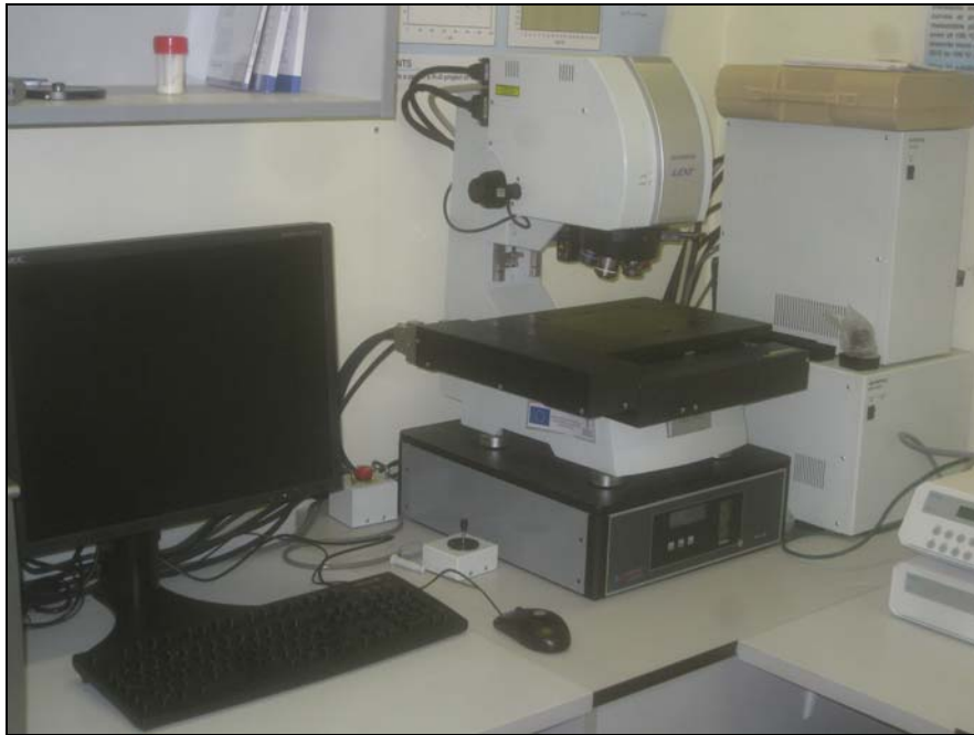
Figura III.2: Fotografía del microscopio confocal utilizado en la Tesis Doctoral.
