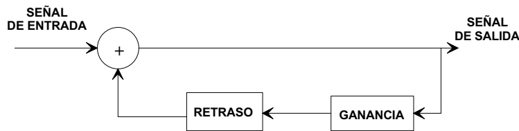
Figura 3.30: Esquema de la implementación de un eco infinito por el cual la señal de salida es una suma retardada y pesada por una ganancia de las muestras de salida anteriores.
