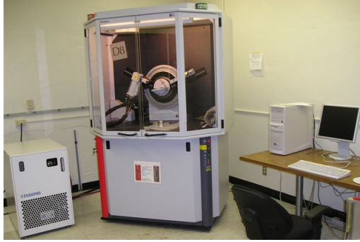
Figura 3.7: Sistema D8 de Bruker en que se realizaron las medidas de XRD en este trabajo.
