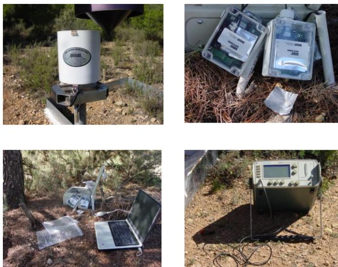
*Figura 3. 10. A; Instrumentación de campo. Pluviógrafo. B; Data loggers. C; Descarga de datos en pc. D; Time Domain Reflectometric (TDR).*
