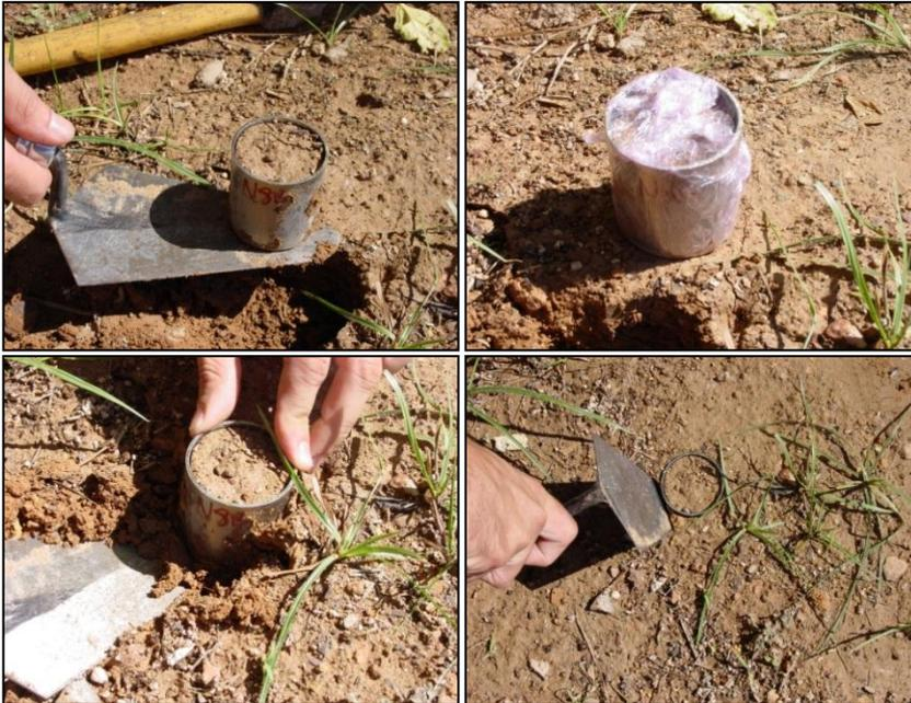
Figura 4. 1. Detalle de la extracción de los cilindros para BD.
