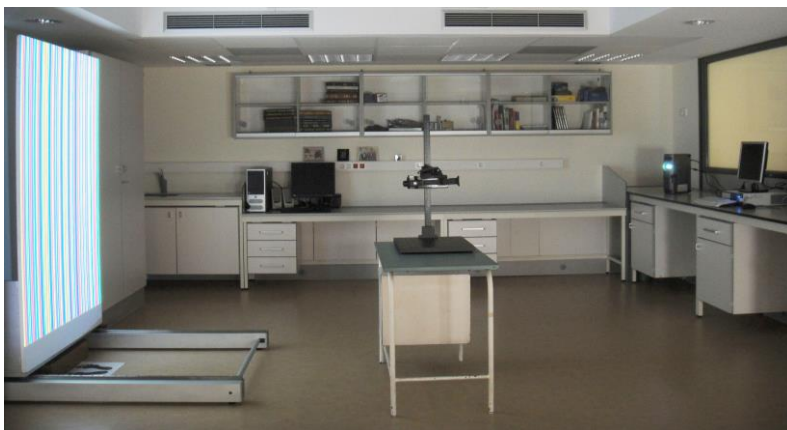
Figura 3.3. Montaje experimental: pantalla móvil, cámara digital y proyector.
