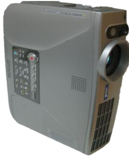
Figura 3.6. Proyector del patrón de luz estructurada
