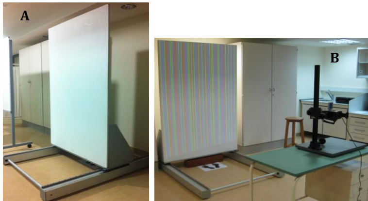
Figura 3.4. Pantalla móvil (A) y patrón de luz codificado proyectado sobre ella (B)
