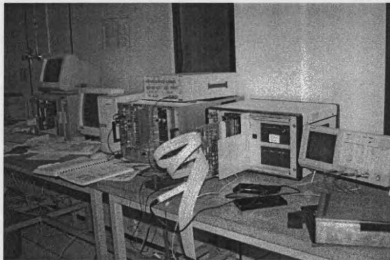
Figura 6.4: Dispositivo experimental empleado para la caracterización y análisis de la electrónica binaria basada en LBIC+CDP y CAFE+CDP.
