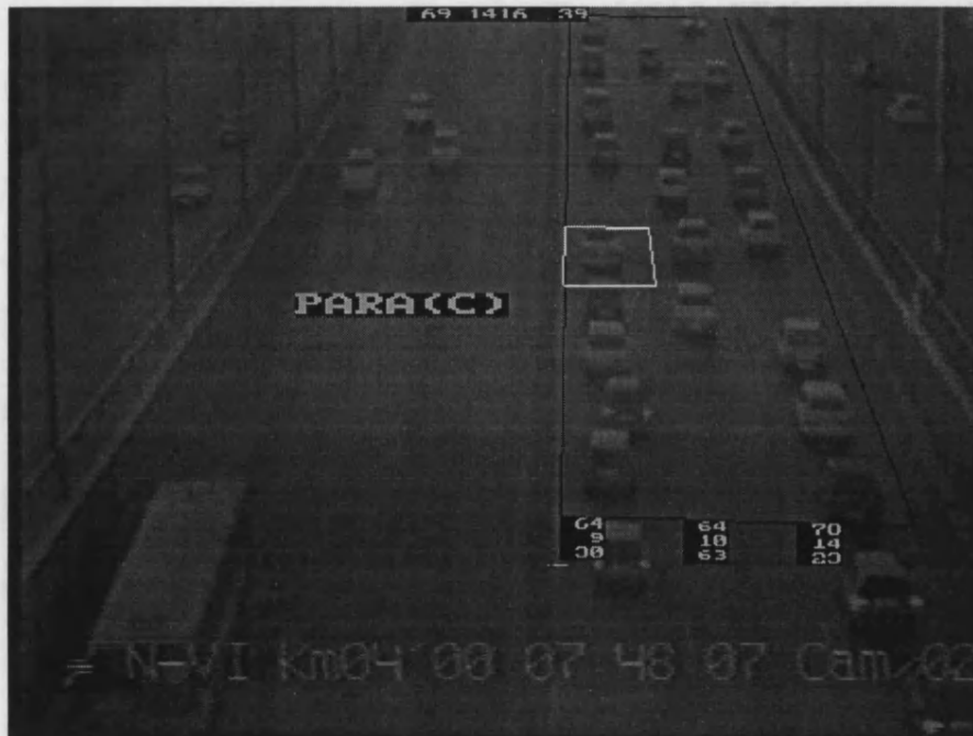
Figura 47.- Detección de un vehículo parado en congestión.
