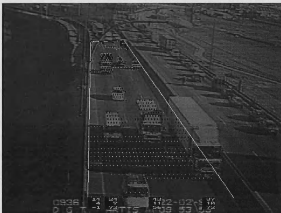
Figura 15.- Resultado del proceso de filtrado de sombras en una imagen con sombras grandes.
