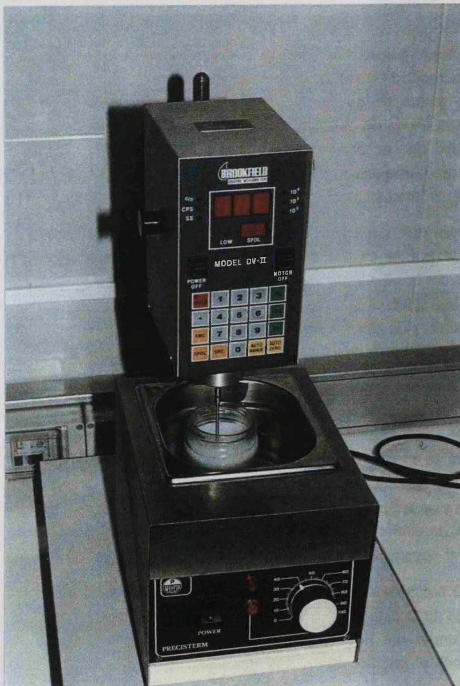
**Figura 2.4.** Montaje experimental utilizado para medir la viscosidad de los geles. Viscosímetro Brookfield Digital DVII (con husillo cilíndrico) y baño termostático.
