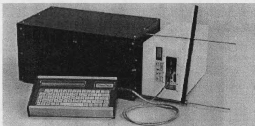
Figura 2.37 El Li-1800 ensamblado al dispositivo de calibrado
