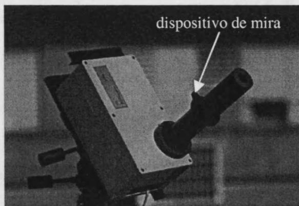
Figura 2.35 El Li-1800 con el colimador acoplado
