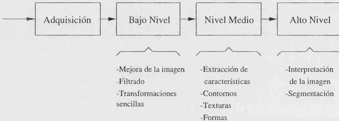
Figura 2.1: Niveles de procesamiento para una aplicación típica de visión artificial
