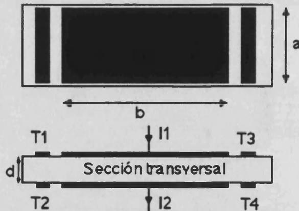
FIGURA II.6. Disposición de los contactos eléctricos para las medidas de resistividad en la dirección del eje c.
