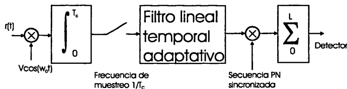
Figura 3.9: Esquema del receptor DS con filtro adaptativo para la eliminación de interferencias de banda estrecha. Dicho receptor está formado por un correlador centrado en la frecuencia de la portadora \omega_0 , un integrador sobre el periodo de un chip T_c , el filtro adaptativo y por último el correlador y el sumador para comprimir la señal.
