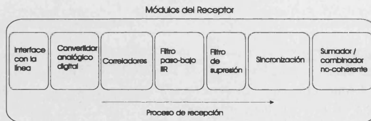
Figura 7.6: Módulos que integran el receptor desarrollado dentro del proyecto PRIFEM. El primer módulo es analógico y forma el interface con la línea. El segundo módulo es el conversor analógico/digital, que muestrea la señal. Los correladores y el filtro paso-bajo llevan a banda base la señal. El filtro de supresión elimina las interferencias. El sincronizador determina el instante de comienzo de los símbolos y el último módulo completa la recepción no-coherente.
