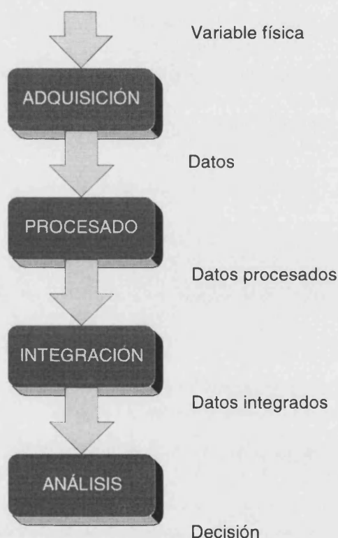
FIGURA 1.1 Sistema de procesado de sensores típico.
