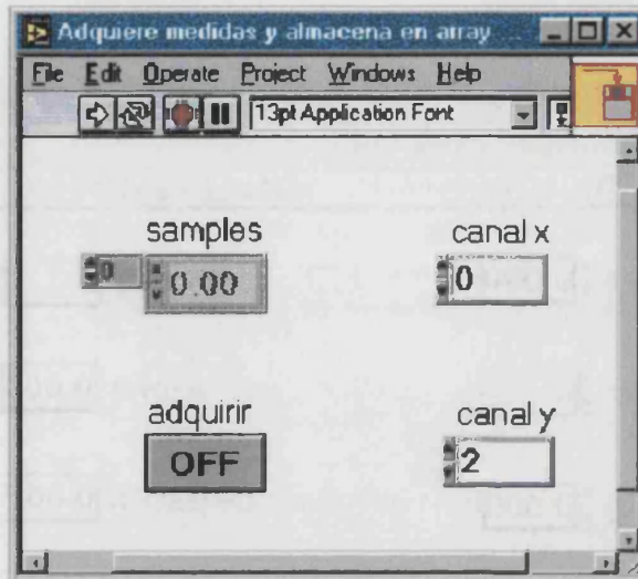
Figura B.4: Panel frontal de la subrutina "Adquiere y almacena en array.vi" desarrollada para almacenar en un fichero los datos adquiridos y actualizar las gráficas.
