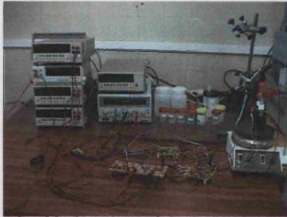
Figura 4.2: Banco de pruebas del primer sistema de instrumentación implementado, circuito de polarización V_{ds} constante e I_{ds} variable.
