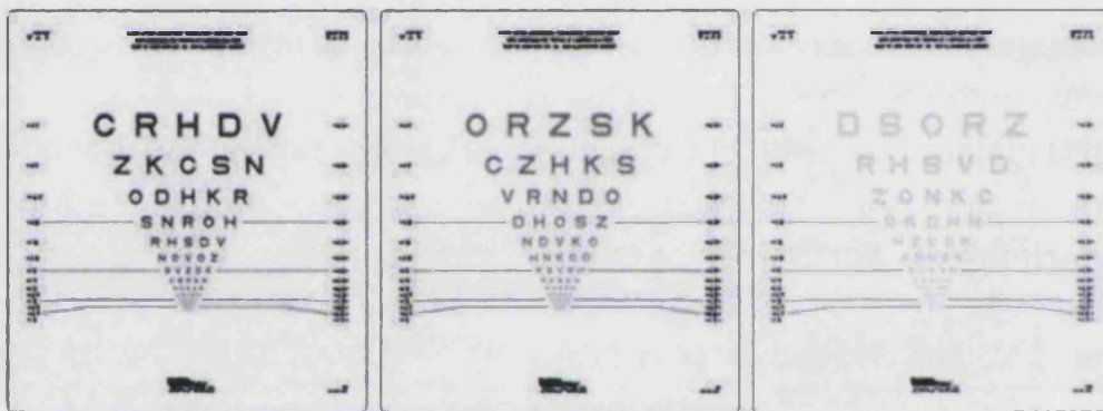
Figura 3.13. Juego de tres cartas Sloan Low Contrast de Precision Vision con niveles de contraste 25%, 10%, 5%.
