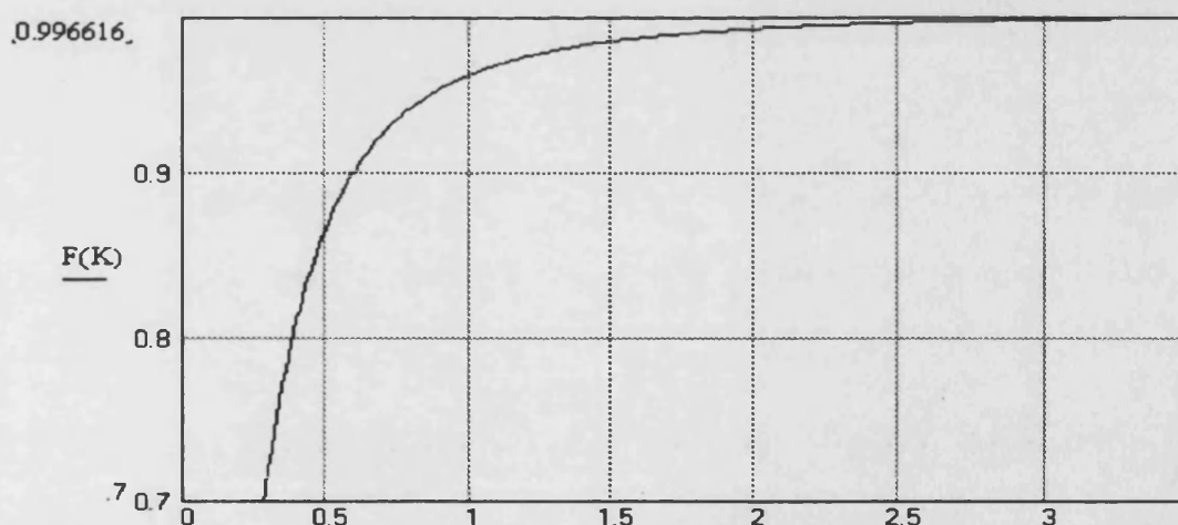
Figura II.5 Representación de la variación del factor de potencia (eje Y) con el factor K=I_m/\delta .
