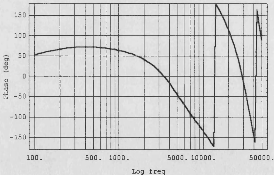
Figura 6.13.: Fase del diagrama de Bode de la función de transferencia en lazo abierto del lazo de tensión del rectificador tipo BUCK. Aunque el ancho de banda es de sólo 500Hz, vemos que podemos llegar a 1kHz manteniendo un margen de fase razonable.
