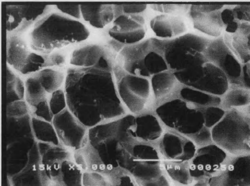
Figura 5.3. Estructura microscópica de un gel ácido de leche obtenido en caliente (90°C) a pH 5.3, con adición de gelatina (1.5%).
