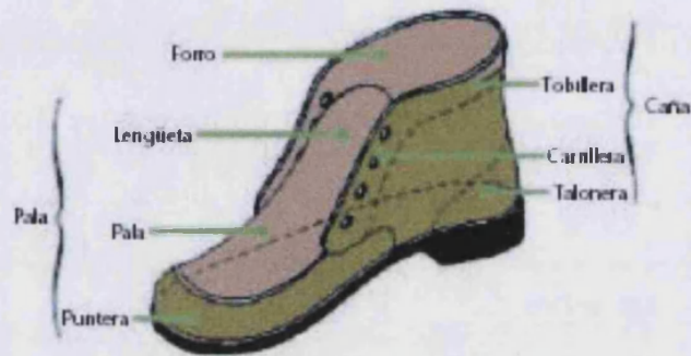
Figura 39. Partes del Calzado
