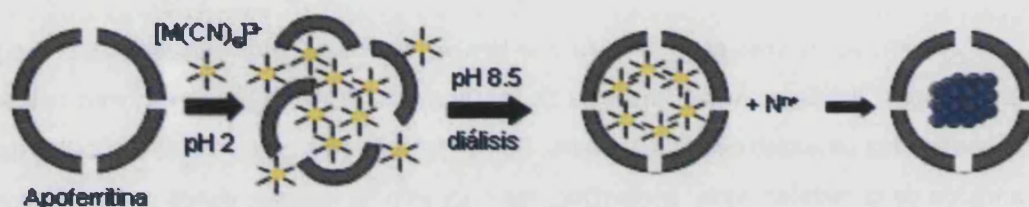
Figura 3.1.2. Preparación de nanopartículas bimetálicas ( \text{M}^m\text{N}^n ) encapsuladas en apoferritina.
