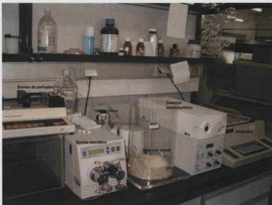
Figura 2.8. Vista del equipo empleado en los experimentos de microdiálisis
