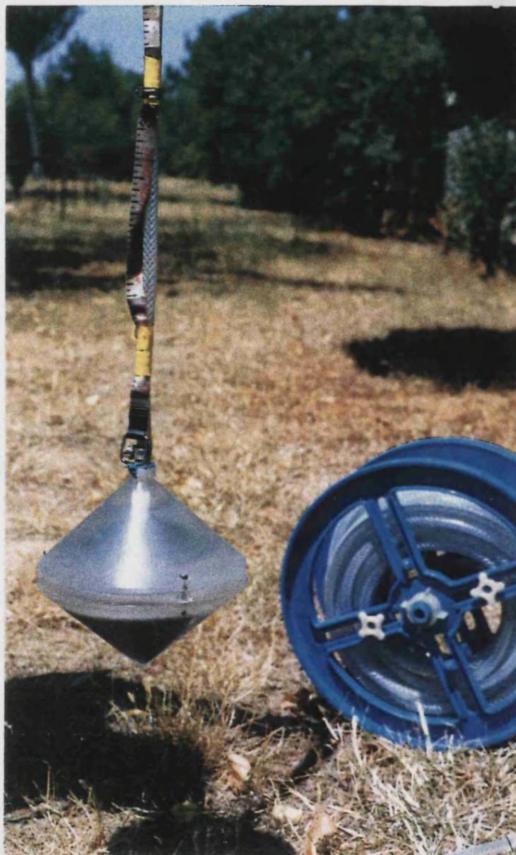
Figura 3.1. Muestreador de doble cono usado en la toma de muestras.
