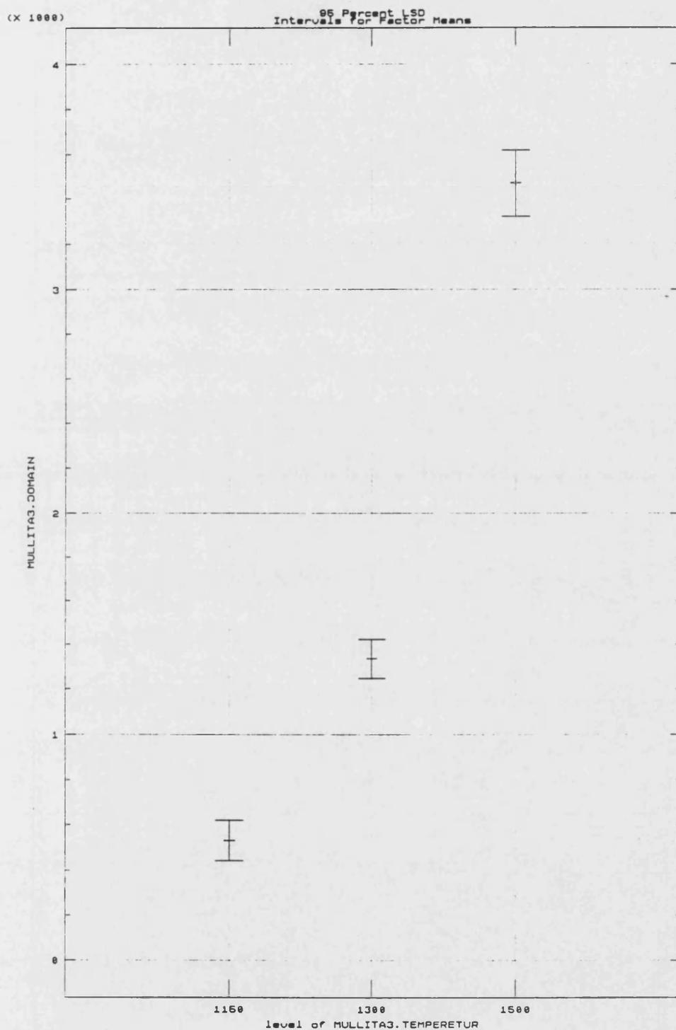
Figura 5b. Medias de los grupos muestrales (ordenadas, en Å) correspondientes a la temperatura (Las barras de error indican un intervalo de confianza del 95 % para la predicción de la media).
