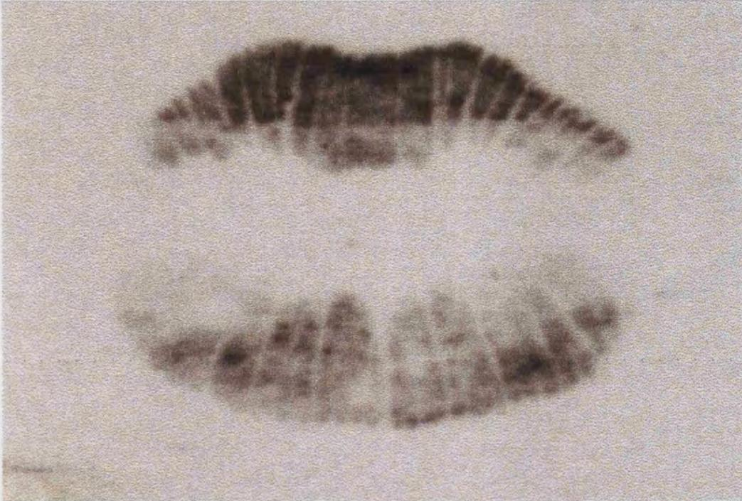
*Ilustración n° 33:* revelado con óxido de cobalto a los 15 días de huella impresa con lápiz labial sobre cerámica blanca.
