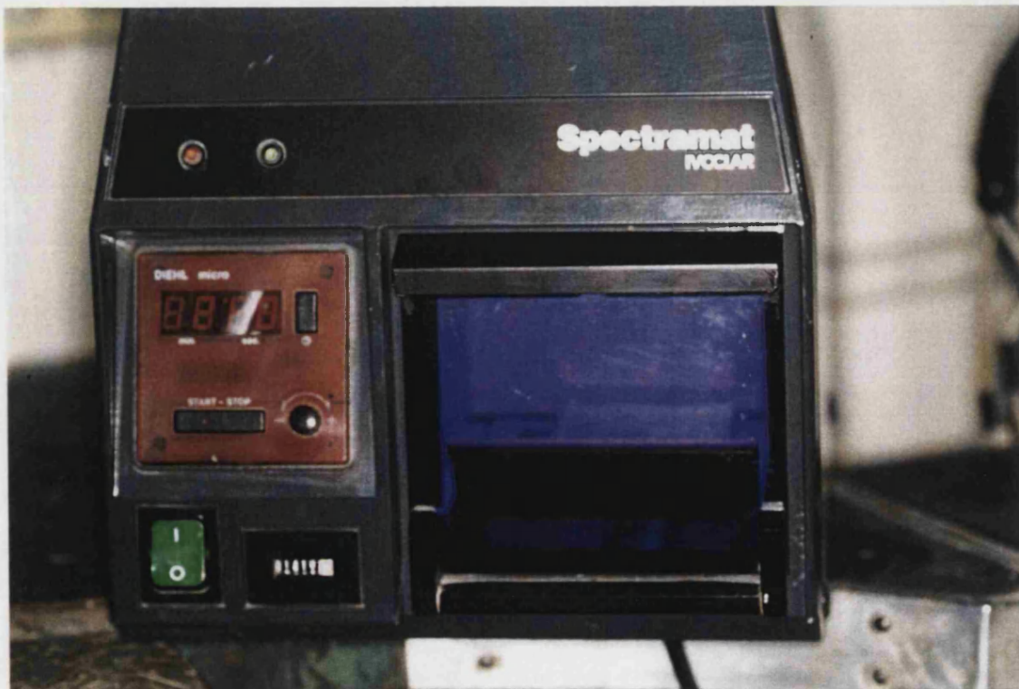
Figura 17. Proceso de fotopolimerización en horno de luz halógena.
