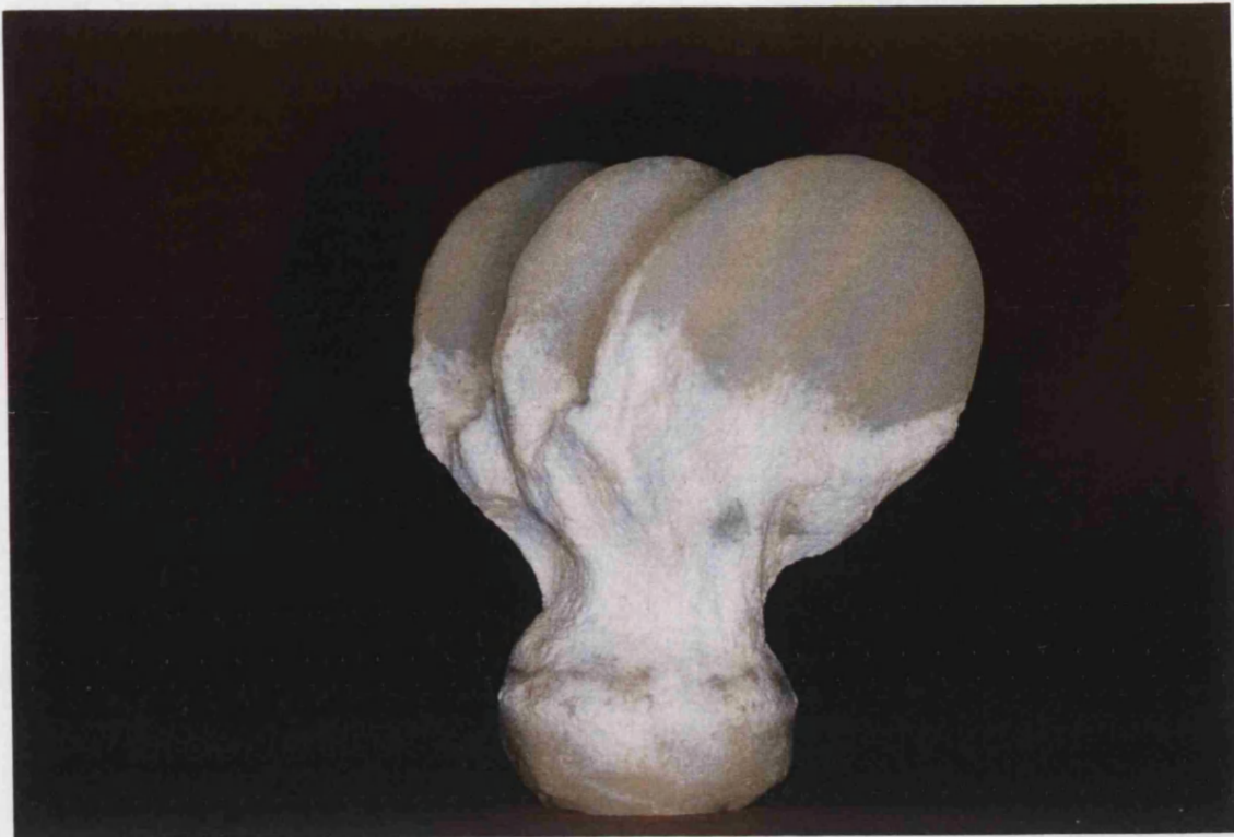
Figura 20. Discos de cerámica tras la fase de inyección y eliminación de revestimiento.
