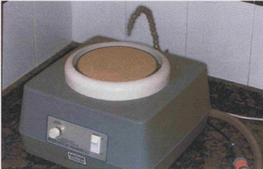
Fig. 13: Pulidora para obtener secciones dentarias por desgaste.
