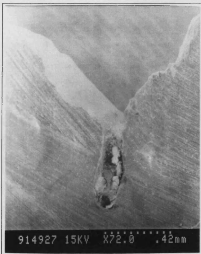
Fig. 7.- Fisura tipo Y, tras su apertura con una fresa de diamante
