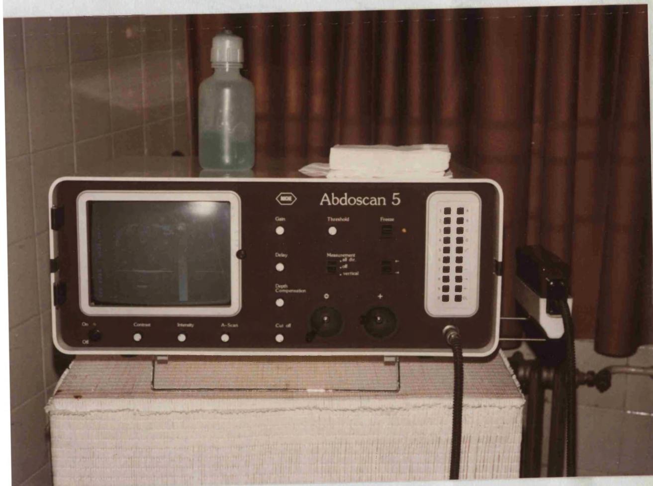
Foto 15 : ABDOSCÁN 5 . Ecógrafo bidimensional dinámico (tiempo-real) multicristal de la firma Kontron . Lleva incorporado A-mode de registro simultáneo , así como salida para TM-mode . Permite mediante un sistema de computadores el registro inmediato del diámetro biparietal , diámetro torácico , céfalo-nalga y valoración de áreas , así como relacionarlo inmediatamente con la semana gestacional .
