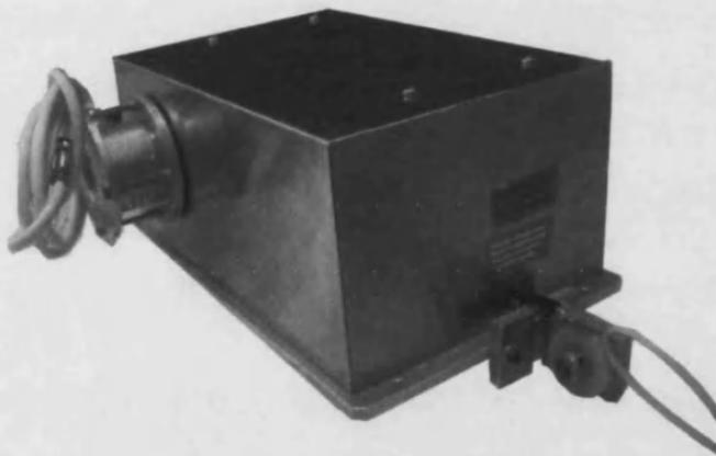
**Figura II.1. Transductor de posición SportMetrics®**
