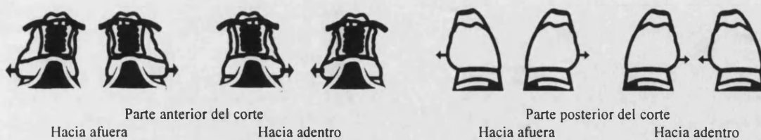
Figura 28: Alternativas de deformación del material de corte.
