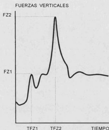
Figura 50: Fuerzas verticales de reacción en función del tiempo (CI: Contacto inicial; CA: Contacto del antepié; CT: Contacto del talón).
