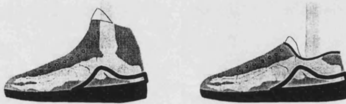
Figura 15: Esquema de dos zapatillas con contrafuerte.
