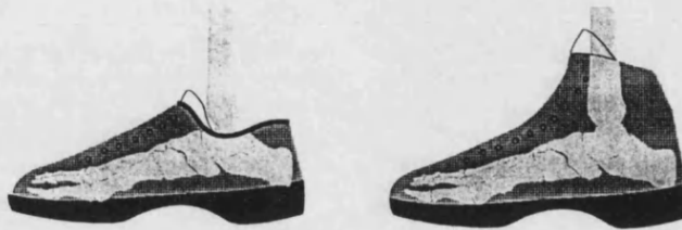
Figura 17: Esquema de dos zapatillas con vaciado en la entresuela.
