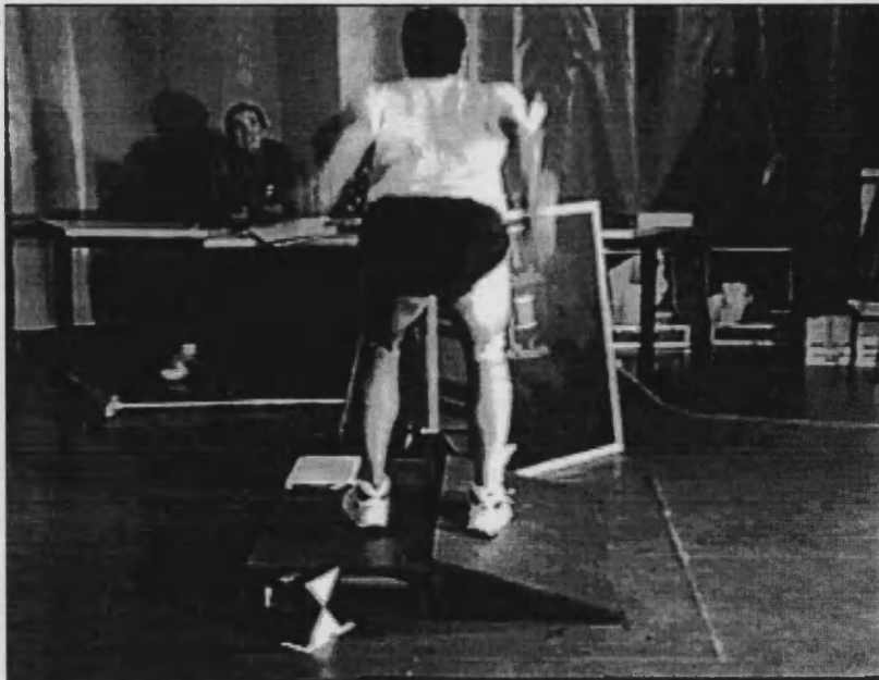
Foto 2: Ensayo de saltos con aterrizaje sobre el plano inclinado.
