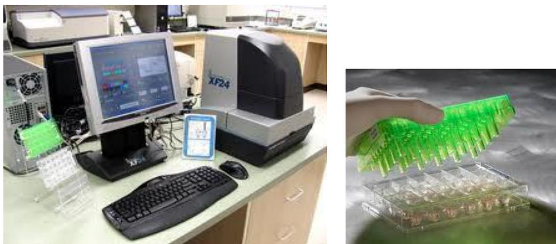
**Figura III.5. Analizador de flujo extracelular Seahorse XF24, acoplado a un ordenador con el software XF y una microplaca de 24 pocillos para cultivo celular con su cartucho e inyectores.**
