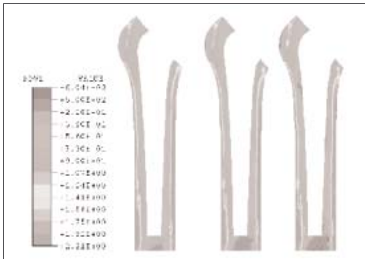
Figura 5. Distribución de densidades tras 100, 200 y 300 días de simulación, tras la incorporación del vástago Exeter.
